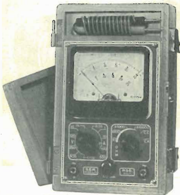
Super Analizzatore Mod. 603 20.000 ohm/Volt
